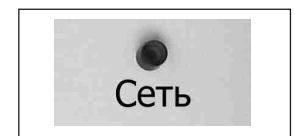
Рис. 7. Индикатор включения сети
