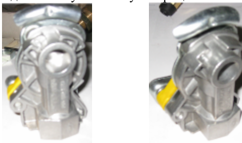
Рис.7. Головка соединительная типа «Б»: корпус; стержень; кольцо уплотнительное; гайка прижимная; крышка
