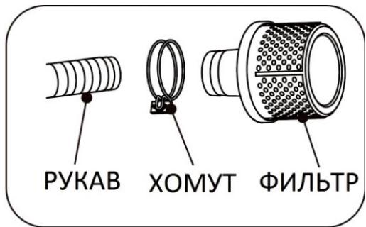
Подключение фитингов к всасывающему патрубку насосной части осуществляется в следующем порядке:
