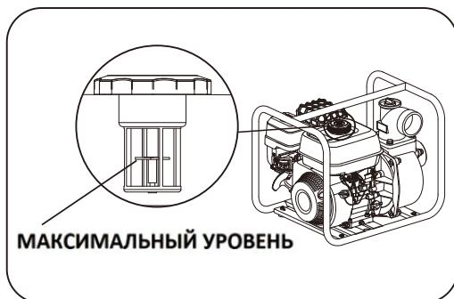
Рисунок 5. Максимальный уровень заполнения топливного бака.
