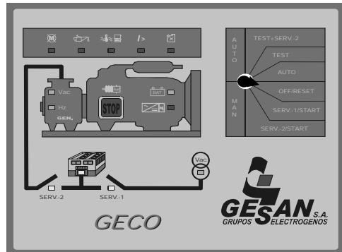
Затем переключатель переводится в положение АВТО. При наличии основной сети после трёхминутной задержки, необходимой для проверки стабильности сети, размыкаются контакторы между генератором и нагрузкой, и замыкаются контакторы между сетью и нагрузкой. Следующие две минуты генератор работает в режиме холостого хода, затем двигатель останавливается.
