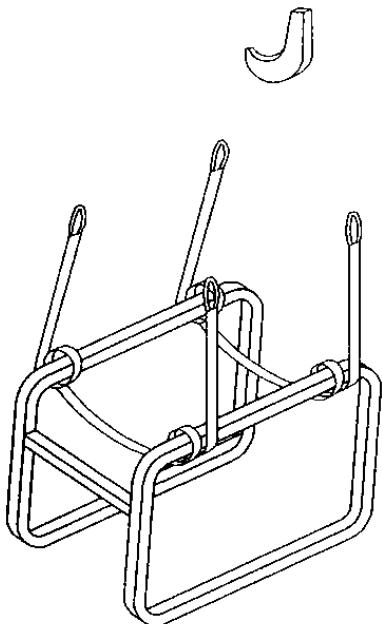
Чтобы перенести генератор, надежно прикрепите к его каркасу два стропа, как показано на рисунке.
