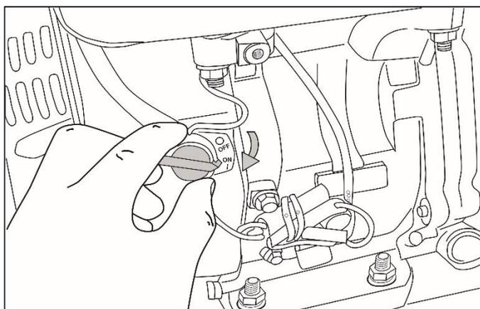
Рис. 26. Выключение зажигания.
