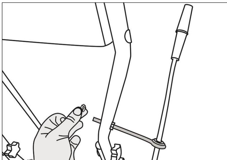
Рис. 12. Установка передней части рычага поворота желоба.
