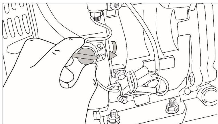
Рис. 20. Включение зажигания
