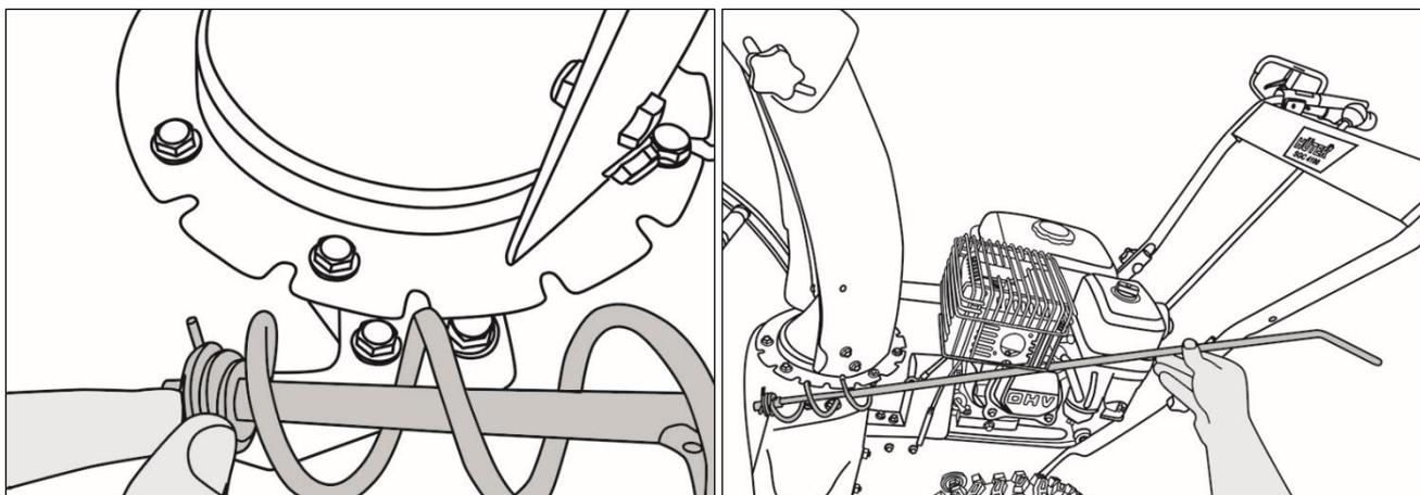
Рис. 11. Установка передней части рычага поворота желоба
