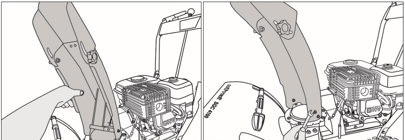
Рис. 10. Установка желоба выброса снега
