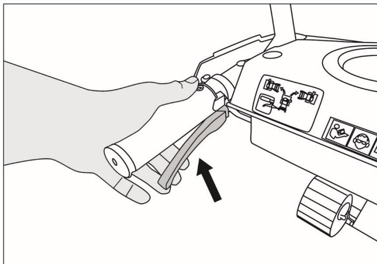
Рис. 25. Рычаг поворота.
