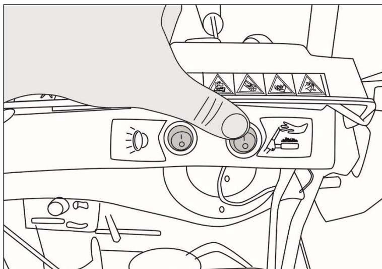
Рис. 23. Кнопки включения фары и подогрева рукояток
