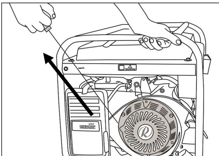
Рис. 16. Запуск двигателя ручным стартером
