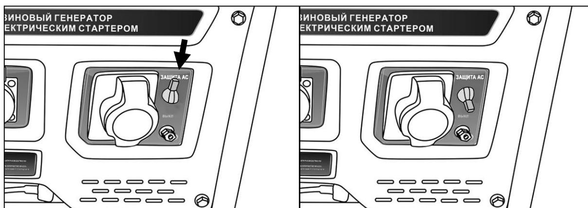
Рис. 12. Автоматический выключатель
