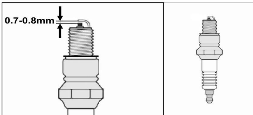
Рис. 23. Свеча зажигания
