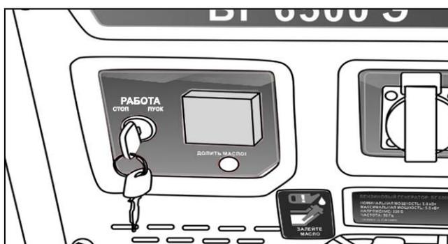
Рис. 20. Многофункциональный цифровой дисплей.
