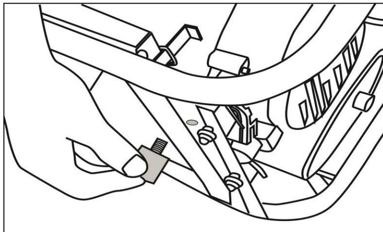
Рис. 2. Установка резиновых опор
