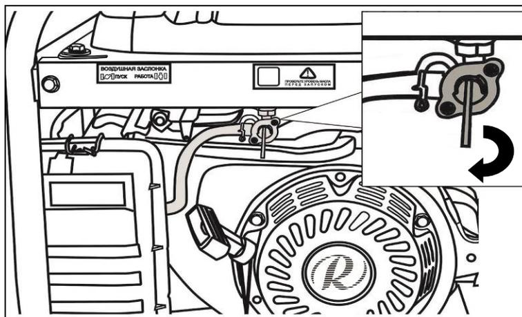
Рис. 13. Топливный кран
