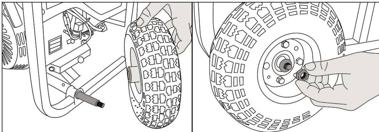
Рис. 4. Установка колёс
