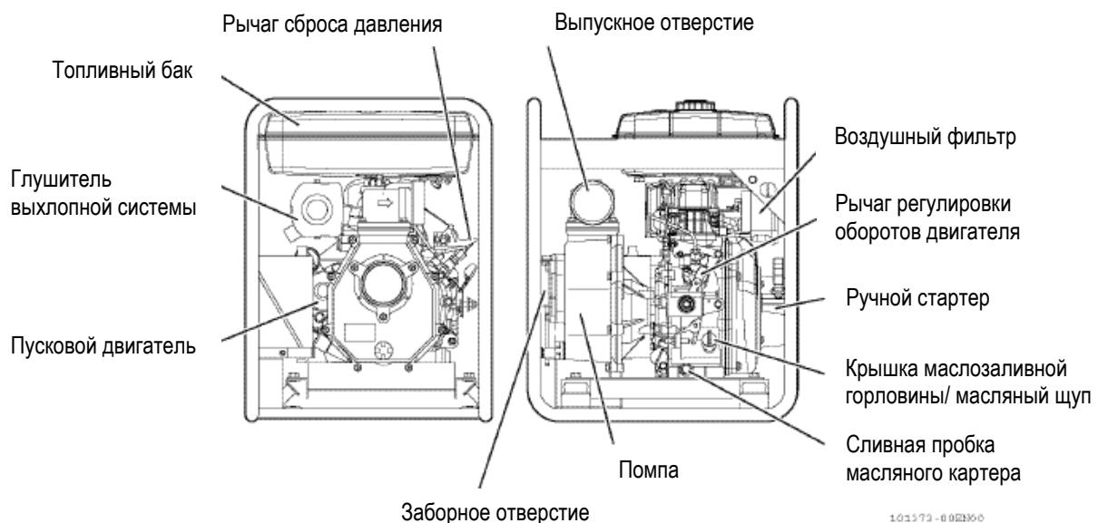
Тип: мотопомпа для слабозагрязненной воды
