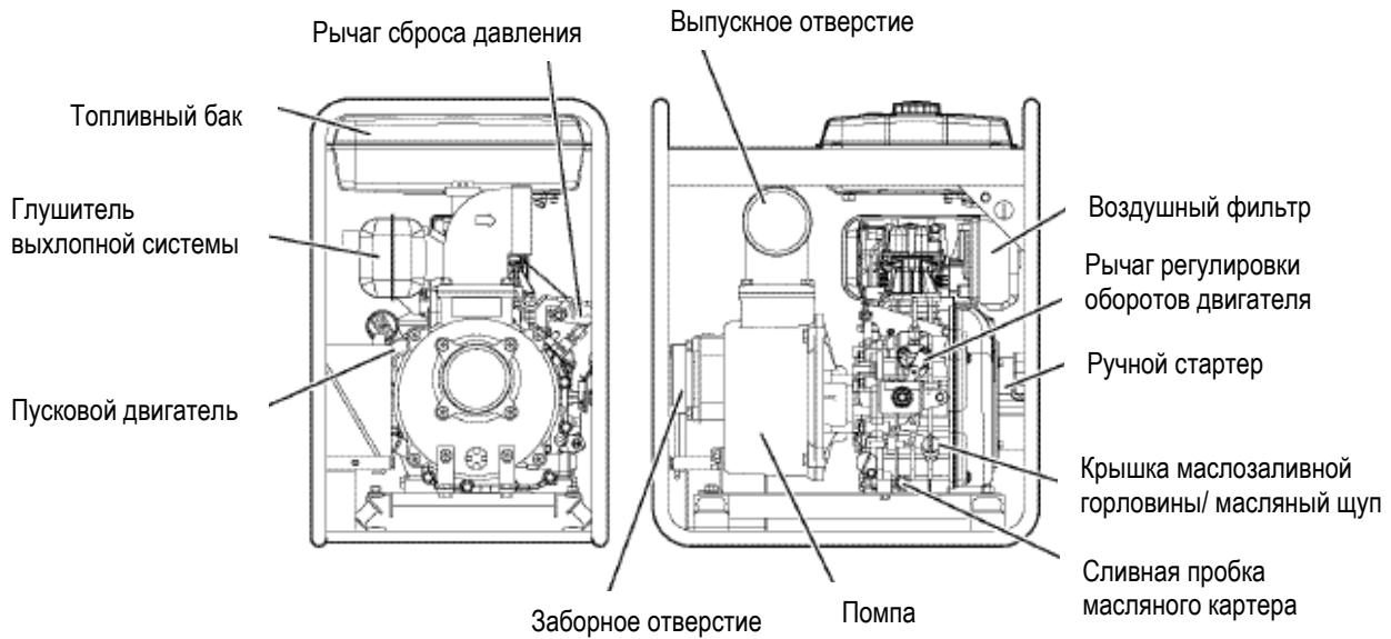
**Тип: мотопомпа для грязной воды**
