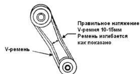
Рис. 2 Натяжение V-ремня
