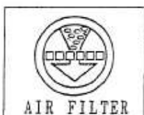
Засор воздушного фильтра
