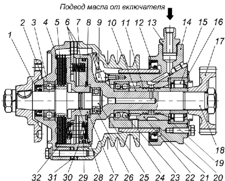
Рис. 1. Привод вентилятора
