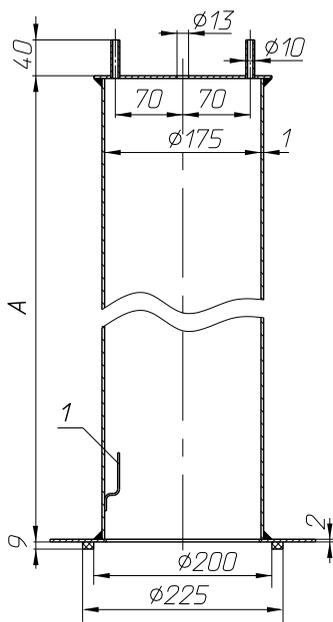
Рис. 23. Заглушка для проверки герметичности впускного тракта:
