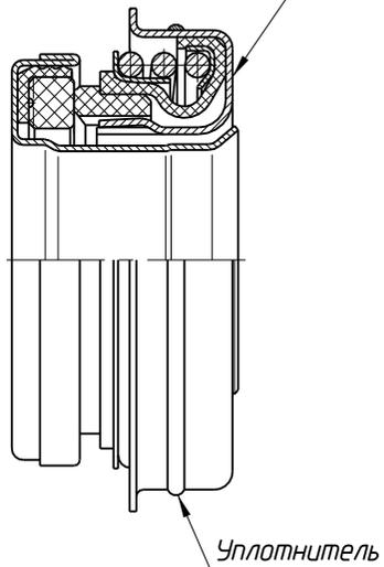
Рис. 24. Водяной насос с торцовым уплотнением "КАСО"
