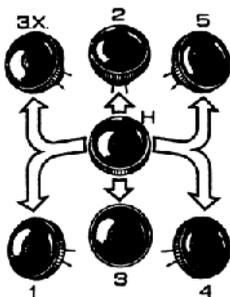
Рис. 8. Схема положений рычага переключения передач ЯМЗ-236Н
