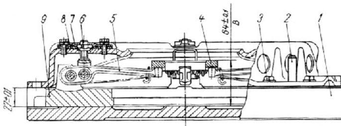
Рис. 27. Приспособление для сборки нажимного диска с кожухом в сборе:
