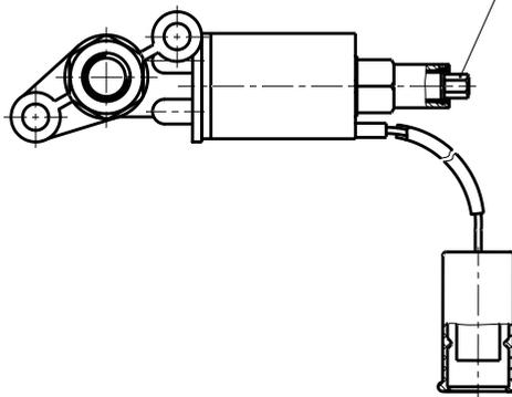
Рис. 32. Клапан электромагнитный КЭМ 32-23М2
