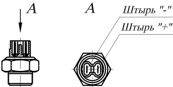
Рис. 33. Термореле
