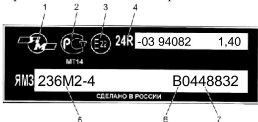
Рис. 30. Заводская табличка двигателя ЯМЗ-236М2-4
