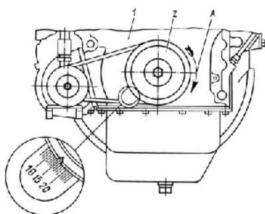
полнены на маховике в буквенном выражении. При этом букве «А» соответствует значение в цифровом выражении  $20^\circ$ , букве «Б» -  $15^\circ$ , букве «В» -  $10^\circ$  и букве «Г» -  $5^\circ$ .
