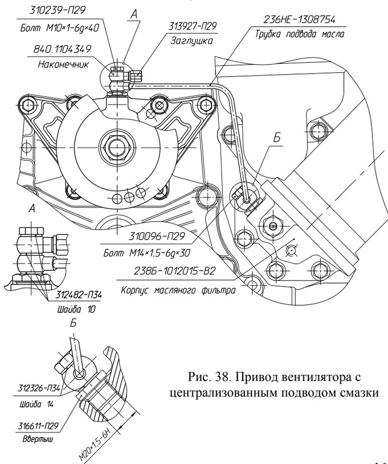
Рис. 38. Привод вентилятора с
