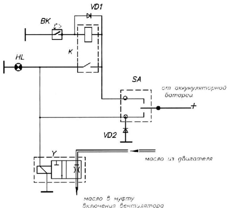
Рис. 34. Схема включения муфты вентилятора электрическая, принципиальная
