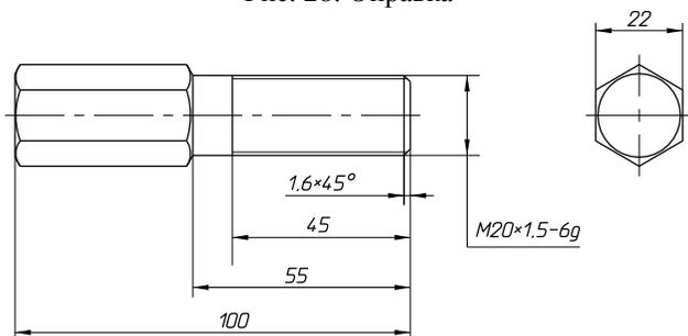
Рис. 29. Установочный винт
