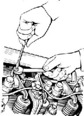
Рис. 16. Отвертывание контргайки регулировочного винта
