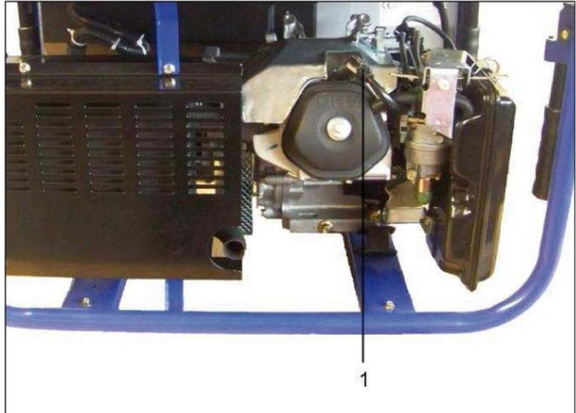
*Рис. 4.7: Извлеките наконечник свечи зажигания*
