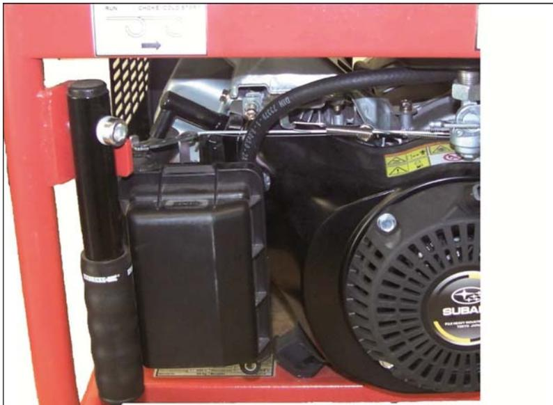
*Рис. 4.8: Снятие воздушного фильтра*
