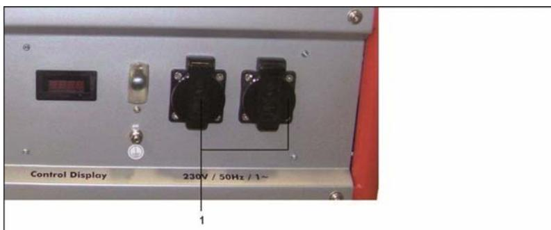
Рис. 4.3: Подключение электроприбора
