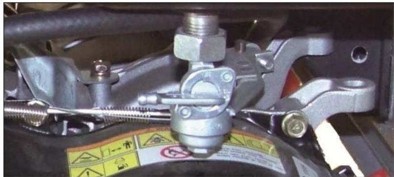
Рис. 4.6: Закрытие топливного клапана
