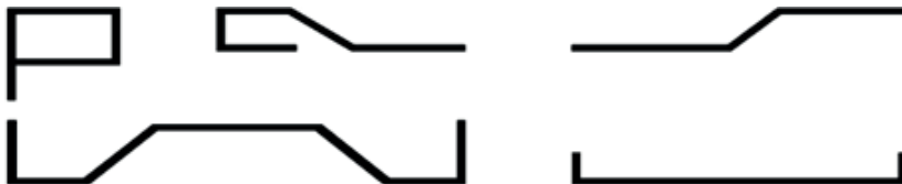
Рис. 5 Формы изгиба арматуры
