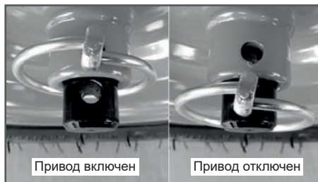
Рис.26 Перестановка шплинта на левом колесе
