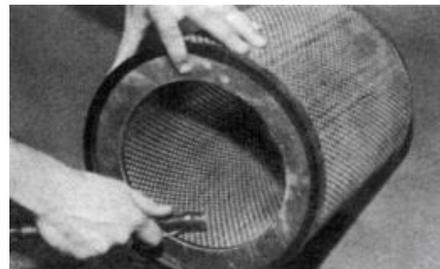
По окончании очистки проверьте фильтроэлемент на отсутствие повреждений. Осмотрите его снаружи. Установите проверочную лампу внутри фильтроэлемента и просветите его. Щели, разрывы, непрочности, деформация внешней или внутренней обечеек или другие повреждения не допускаются. При обнаружении указанных дефектов замените фильтроэлемент.
