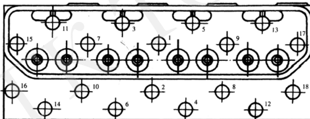
Между блоком цилиндров и головкой цилиндров устанавливается прокладка. Головка цилиндров крепится к блоку цилиндров с помощью 18 болтов, которые необходимо затягивать в указанном порядке (см. рис.) в 3 этапа до момента затяжки 120-140 Нм.
