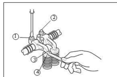
**Примечание:** Зазор выставлен правильно, если щуп может двигаться между клапаном и коромыслом с легким сопротивлением.
