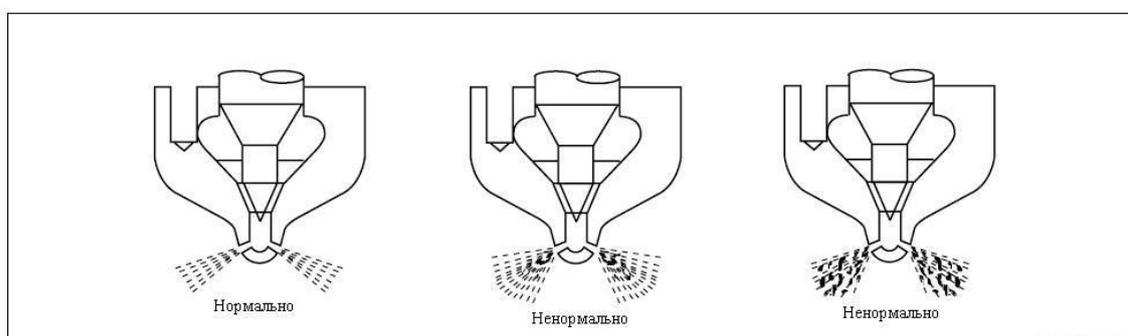
Факел распыла форсунки должно быть равномерным, впрыск должен заканчиваться немедленно без каплеобразования или утечек. Если топливо распыляется неравномерно, форсунки необходимо очистить и проверить вновь.
