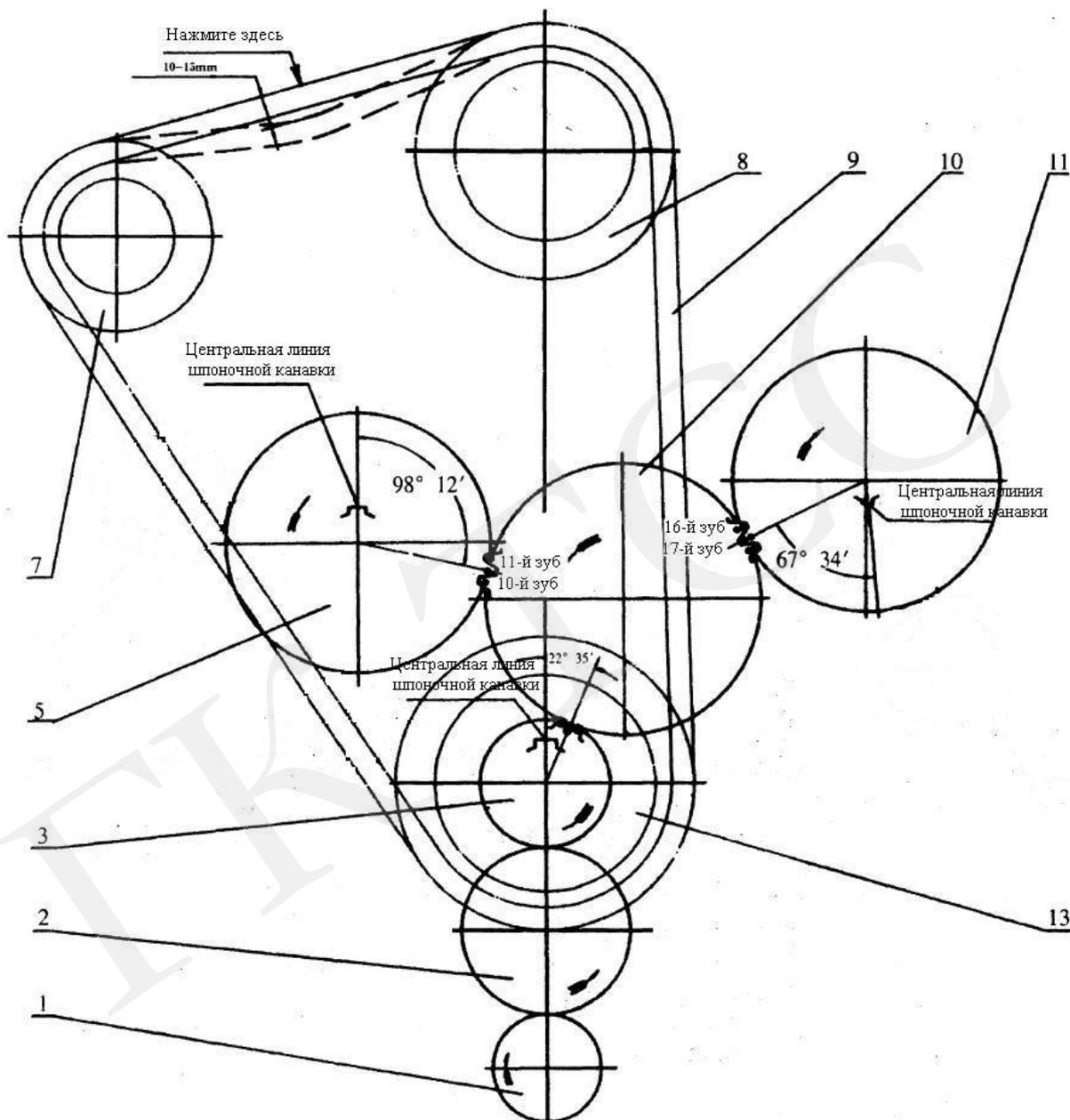
1. Шестерня привода маслонасоса ( $Z = 17$ ). 2. Промежуточная шестерня привода маслонасоса ( $Z = 25$ ). 3. Шестерня коленвала ( $Z = 20$ ). 5. Шестерня привода распредвала ( $Z = 40$ ). 7. Шкив зарядного генератора. 8. Шкив водяного насоса и вентилятора. 9. Приводной ремень. 10. Промежуточная шестерня. 11. Шестерня привода ТНВД. 13. Шкив коленвала.
