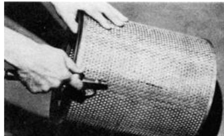
**Примечание:** допускается выполнять очистку фильтроэлемента не более 5 раз, после чего фильтроэлемент воздушного фильтра должен быть заменен на новый.
