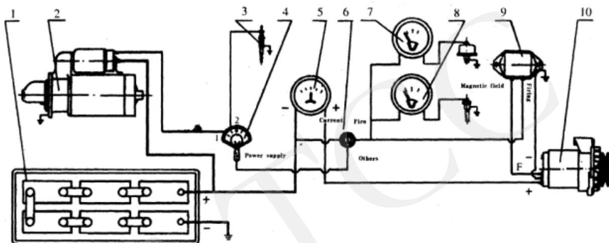
1. Аккумулятор. 2. Стартер. 3. Свеча предпускового подогрева. 4. Переключатель вкл-выкл предпускового подогрева. 5. Амперметр. 6. Ключ запуска. 7. Указатель давления масла. 8. Указатель температуры охлаждающей жидкости. 9. Регулятор напряжения. 10. Зарядный генератор с выпрямителем.
