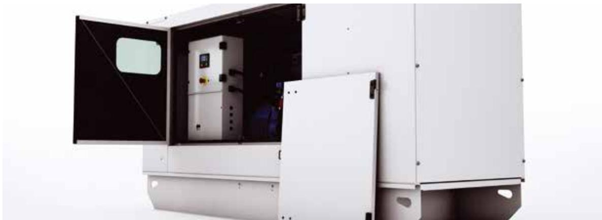
Расположенные с обеих сторон кожуха распашные двери обеспечивают доступ ко всем необходимым компонентам во время монтажа и технического обслуживания генераторной установки. Разъемные петли позволяют полностью снять двери под углом 90°, облегчая обслуживание в условиях ограниченного пространства.
