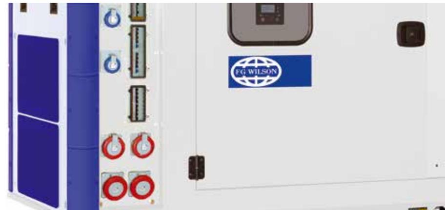
Мы предлагаем ряд дополнительных параметров кожуха CAE, которые позволят наилучшим образом приспособить его к использованию с арендными генераторными установками – розетки CEE и комплект для арендных генераторных установок, который включает 3-позиционный топливный клапан, водоотделитель для топлива, разъединитель аккумулятора, удлиненные разъемы размыкателя цепи.
